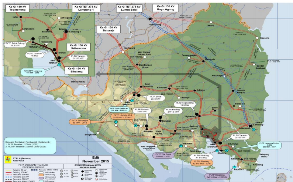
Gambar II-10 Peta Sistem Tenaga Listrik Provinsi Lampung
